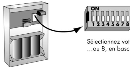
Sélectionnez votre sonnerie GSM 1 ou 2 ou 3 ...ou 8, en basculant le dipswitch désiré sur ON.
